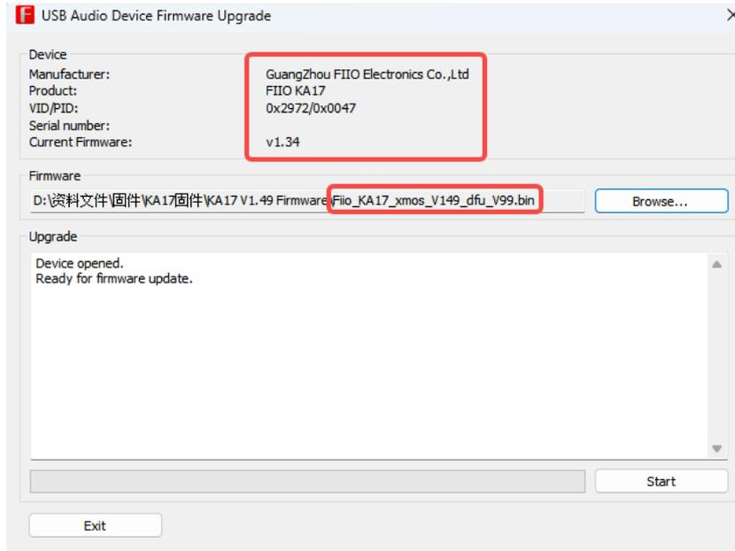
4. 「Firmware upgrade finished successfully」と表示されたら、KA17 とを一度ケーブルから外します。(この時点では Windows コンピューターから USB ケーブルを抜かないでください)、その後再び KA17 を USB ケーブルに接続します。このとき、KA17 の画面に「"Updating, about 3 mins, PLS don' t unplug USB"」と表示されますので、アップグレードが完了するまでしばらくお待ちください。アップグレードが完了すると、KA17 ファームウェアのアップグレードが成功したことを示す「UPDATE OK」という文字が画面に表示されます。
